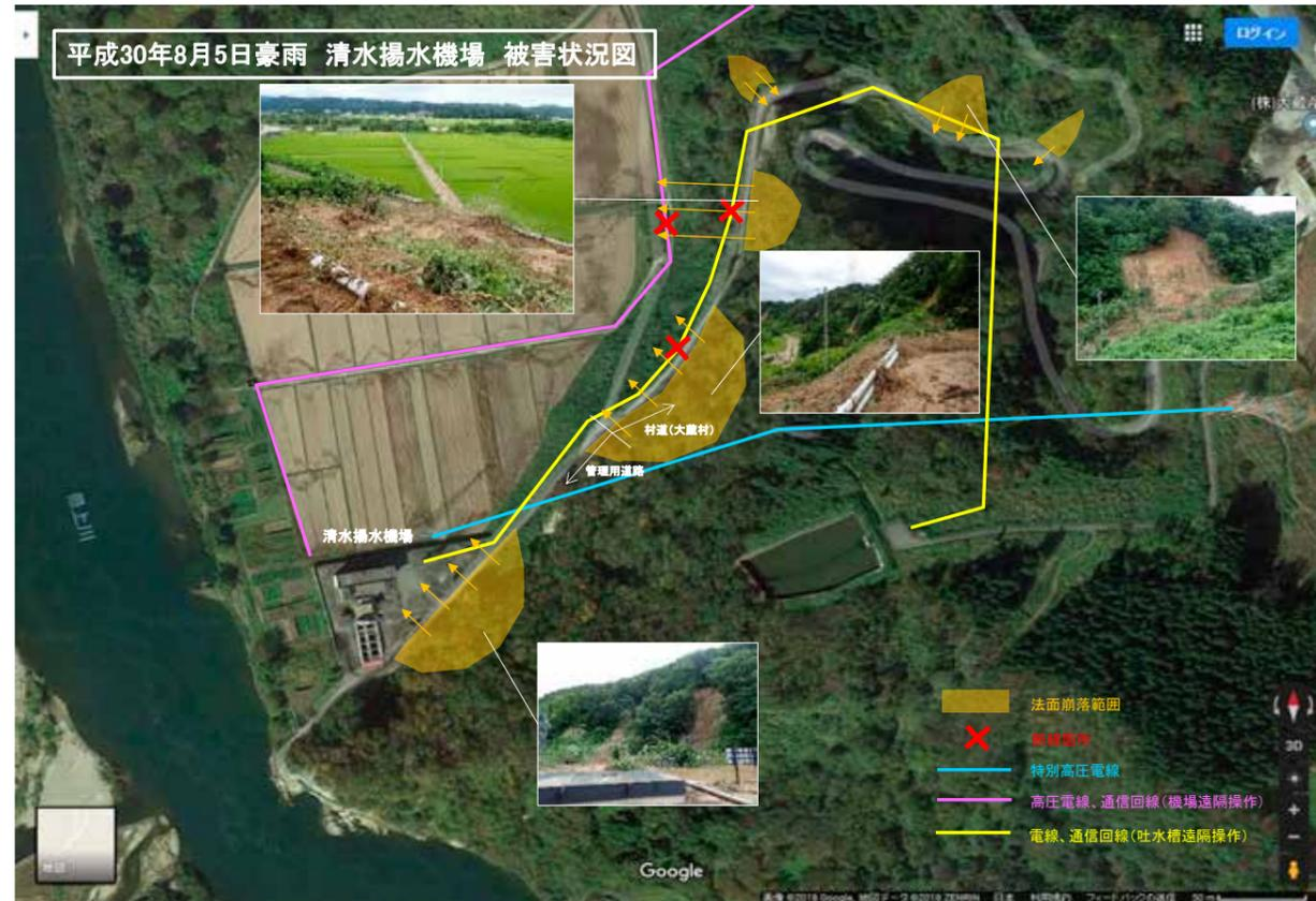
上図のとおり8月5日の豪雨により、清水揚水機場管理道路が6箇所に渡って崩落し、揚水機場はネットフェンスが全壊し、場内や道路は土砂で埋め尽くされました。また、出穂期で大量な農業用水が必要な時期が迫る中、電力柱数本の倒伏、送電線の断線により停電、遠方操作不能という深刻な事態に陥りました。大蔵村のご支援で管理道路の土砂撤去を翌日より迅速に進めていただいたおかげで、5日程で仮復旧を終え貴重な最上川用水を再供給することができました。ご尽力いただいた関係機関、各施工業者の皆さまに心より御礼を申し上げます。組合員の皆様には、大変なご心配をおかけしましたが、ご理解とご協力をいただきましたことに深く感謝申し上げます。尚、昨年12月中に本復旧を完了しております。
